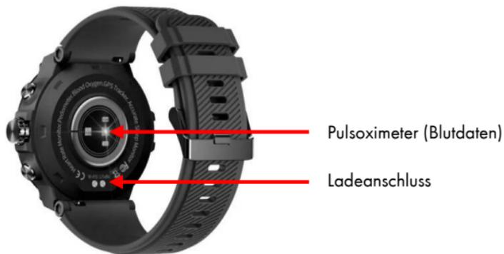
Bitte laden Sie die Uhr vollständig auf, dies dauert ca. 2 Stunden.
