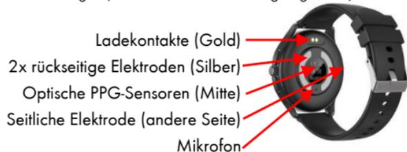
Der Magnet an der Rückseite der Uhr sorgt automatisch für einen passgenauen Halt des Ladekabels. Bitte laden Sie die Uhr vollständig auf, dies dauert ca. 2 Stunden.
