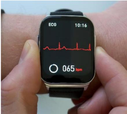
Strom fließt über die Rückseite der Uhr den Arm hoch, am Herzen vorbei und muss über den anderen Arm in die Uhr zurückfließen. Dazu muss ein Finger (vorzugsweise Zeigefinger oder Daumen) den seitlichen EKG-Sensor der Uhr berühren. Idealerweise drücken Sie gleichzeitig die Uhr etwas auf den Handrücken. Während der EKG-Aufzeichnung sollten Sie ruhig sitzen und nicht sprechen.
